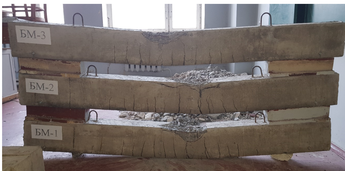
Рис. 3.1 Загальний вид балок серії БМ, зруйнованих за нормальними перерізами
