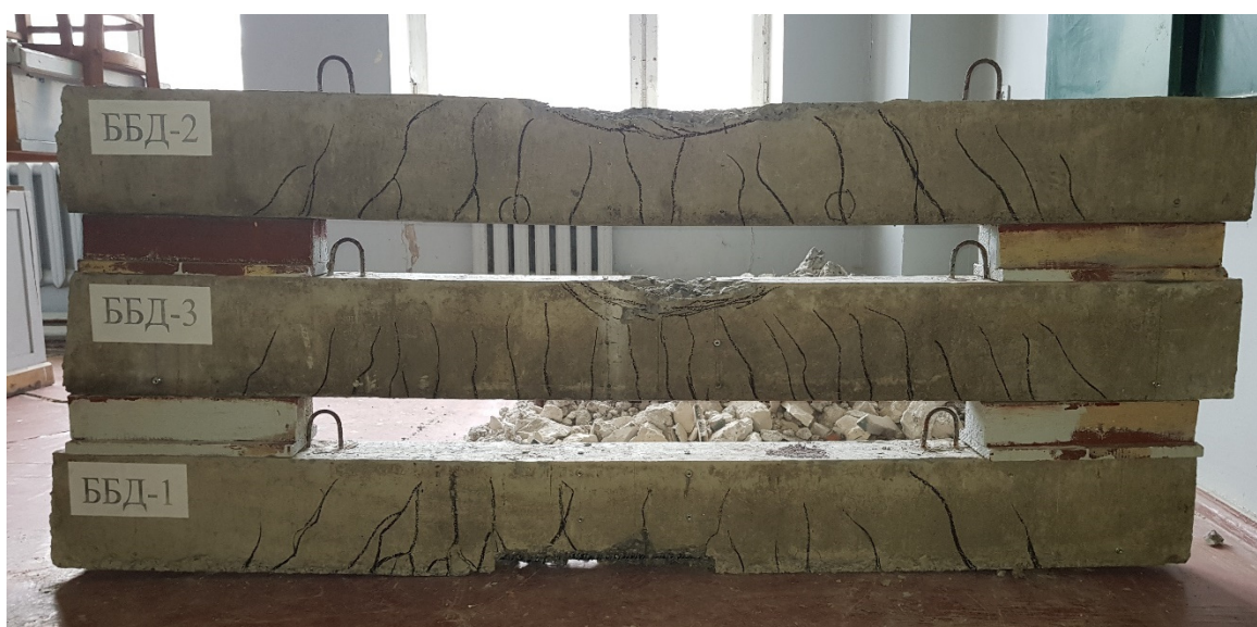
Рис. 3.4 Загальний вид балок серії ББД, зруйнованих змінанням бетону стиснутої зони
