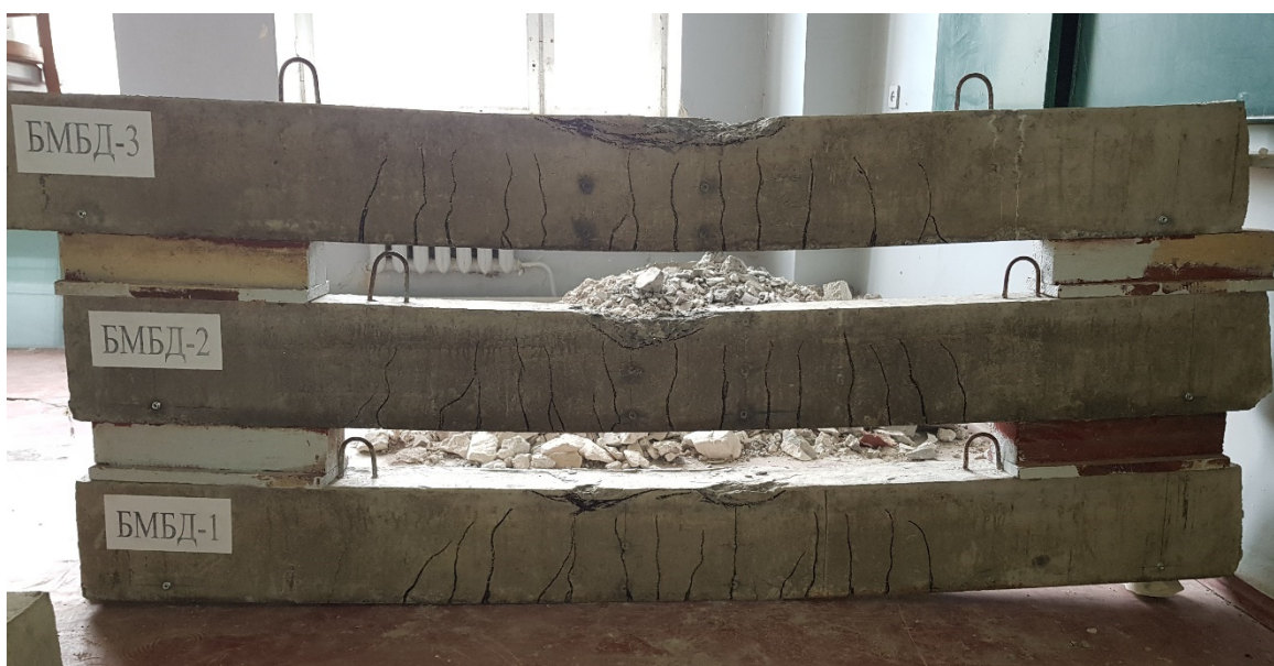
Рис. 3.6 Загальний вид балок серії БМБД, зруйнованих за нормальними перерізами
