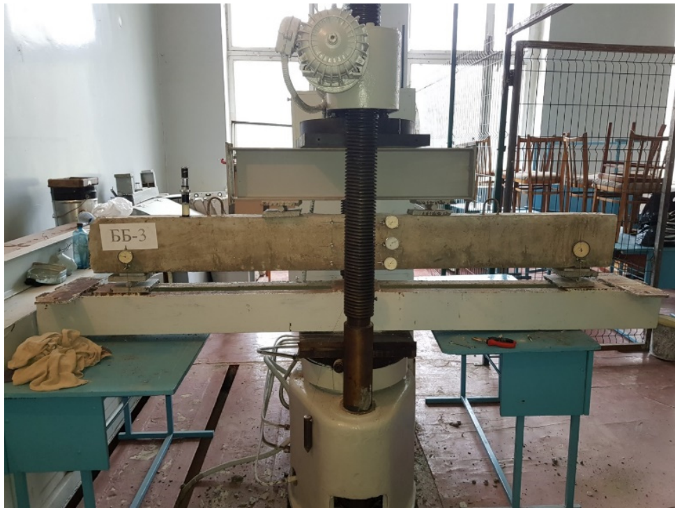
Рис. 2.7 Стенд для випробування балок
