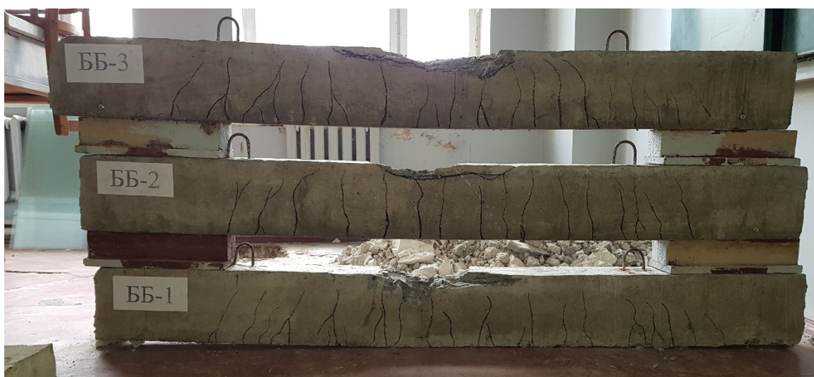
Рис. 3.3 Загальний вид балок серії ББ, зруйнованих змінанням бетону стиснутої зони
