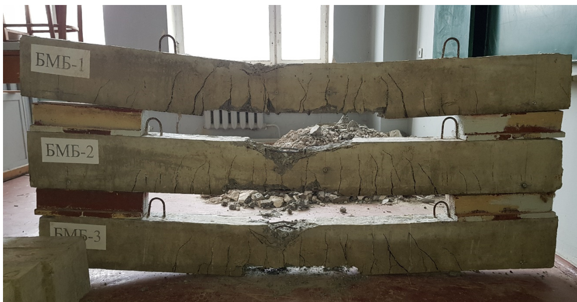
Рис. 3.5 Загальний вид балок серії БМБ, зруйнованих за нормальними перерізами
